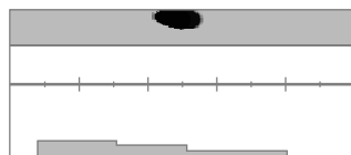
Ta sama śruba wykrywana z różnych kierunków przemiatania cewką, bardziej widoczna identyfikacja żelaza.
